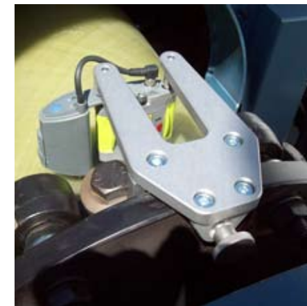
3. Montage sur bride avec fixation sur générateur. Adapté à la plupart des turbines Siemens.
