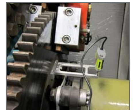
6. Montage sur disque de frein avec fin support magnétique. Adapté à la plupart des turbines GE.
