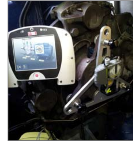
1. Montage pour mesurer sans couplage. Installé sur la bride de la boîte de transfert. Adapté à la plupart des turbines Vestas.
